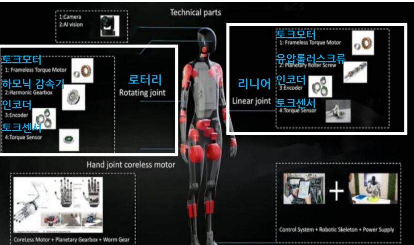
테슬라 옵티머스 Gen2 구조도 (로터리 14개, 리니어 14개)
