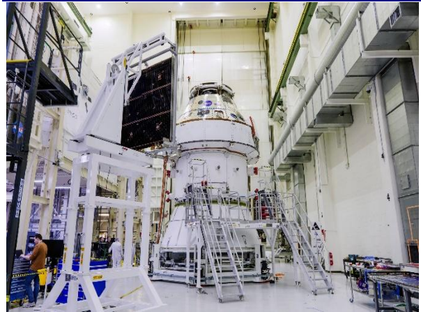
[도표 5] 아르테미스 2 호 오린 우주선에 태양광 날개 설치하는 모습
