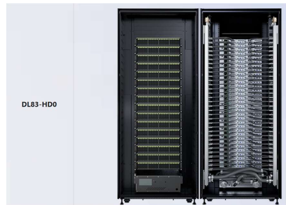
[도표 16] Gigabyte 액체 냉각 rack 구성
