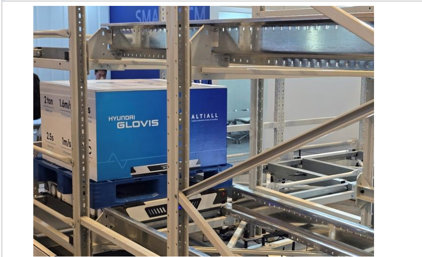
현대글로벌비스 부스: 창고제어시스템(WCS) 플랫폼으로 운영되는 팔레트
