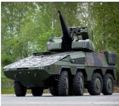
그림1. 스팅어 미사일을 장착한 라인메탈의 Skyranger 30 자주대공포: LIG D&amp;A의 신궁 장착도 가능?
