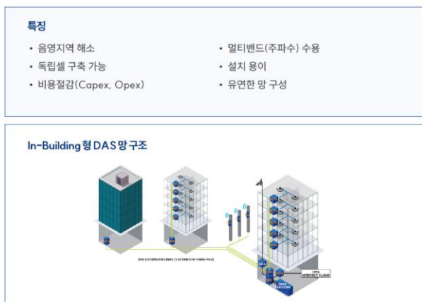
그림5. DAS(광중계기) 구조 및 특징
