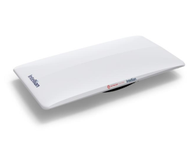
그림66. ESA 기반(전자식 안테나) FPA(Flat Pannel Antenna)의 경우 부피가 작고, 물리적 회전 없이 위성을 추적하기 때문에 LEO 기반 위성통신에 유리
