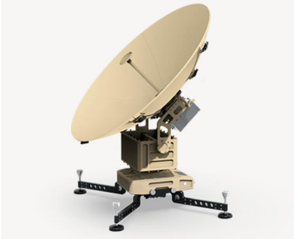
그림3. 기존 위성통신에 활용되던 파라볼릭 안테나의 경우 크기가 크고 기계적으로 위성을 추적하기 때문에 설치 및 이동성 측면에서 제약이 존재
