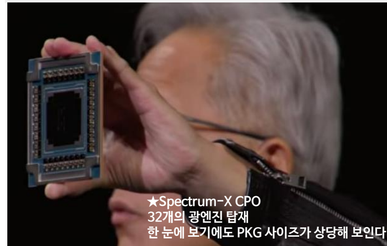
<그림18> Spectrum X CPO의 실물 모습. 패키지가판 가장자리를 둘러싸고 따개비처럼 붙어있는 것들이 전부 광엔진
