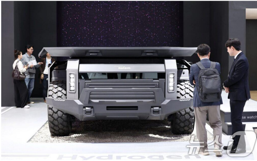
&lt;그림&gt; 수소연료전지 기반의 다목적 무인지상차량(UGV) '블랙 베일'
