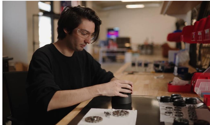
<그림> 대부분의 휴머노이드 업체는 액추에이터 공정을 수작업에 의존
