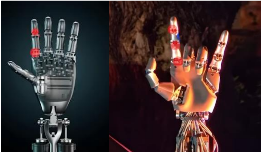
<그림> 좌, 기존 Tesla Optimus 11 DoF 덱스트러스, 우, 새롭게 공개된 Optimus 22 DoF 덱스트러스: 휴머노이드의 덱스트러스는 정교해짐
