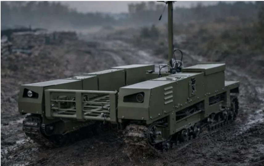
<그림> 우크라이나군 무인 작전에 투입된 보급·공병용 UGV '테르밋(TerMIT)'
