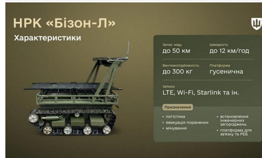
<그림> 우크라이나의 물류 UGV 'Bizon-L': NATO 표준 규격으로 등재
