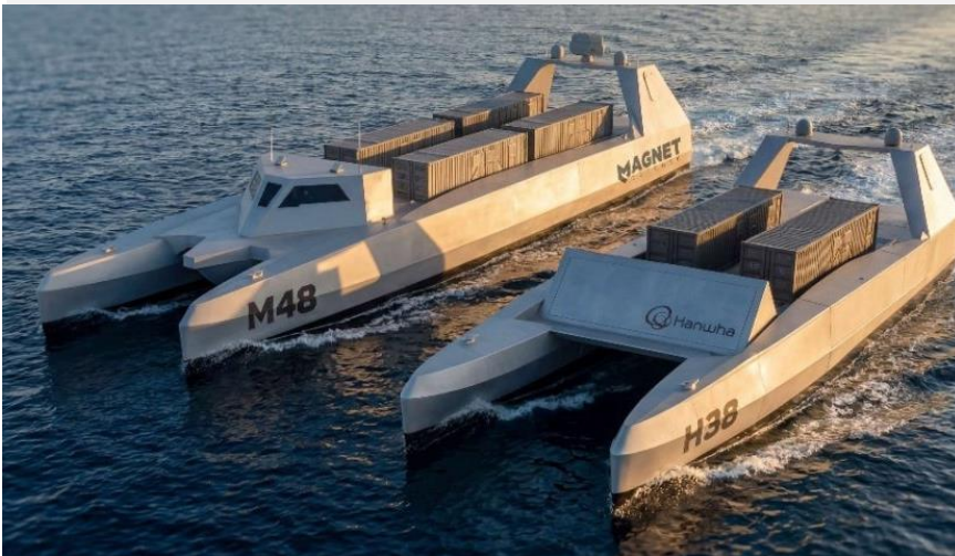
<그림> 마그네티디펜스의 중형 무인수상정 M48을 기반으로, 한화디펜스USA와 공동 개발·생산하는 H38
