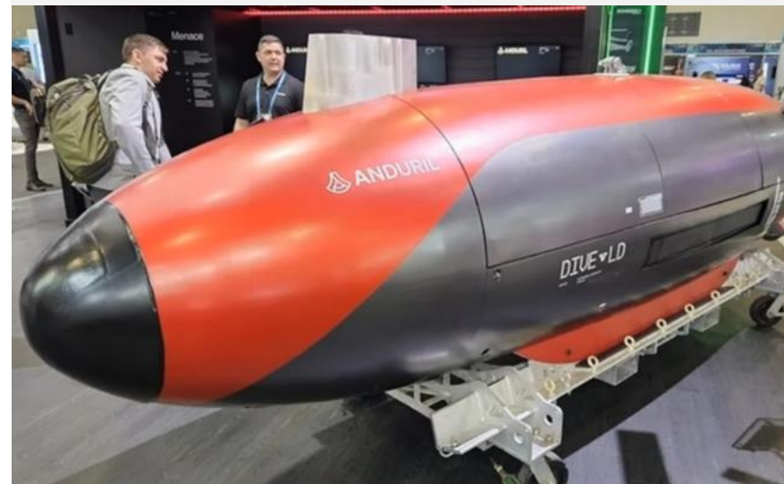
<그림> 안두릴의 자율무인잠수함(AUV) '다이버-LD'
