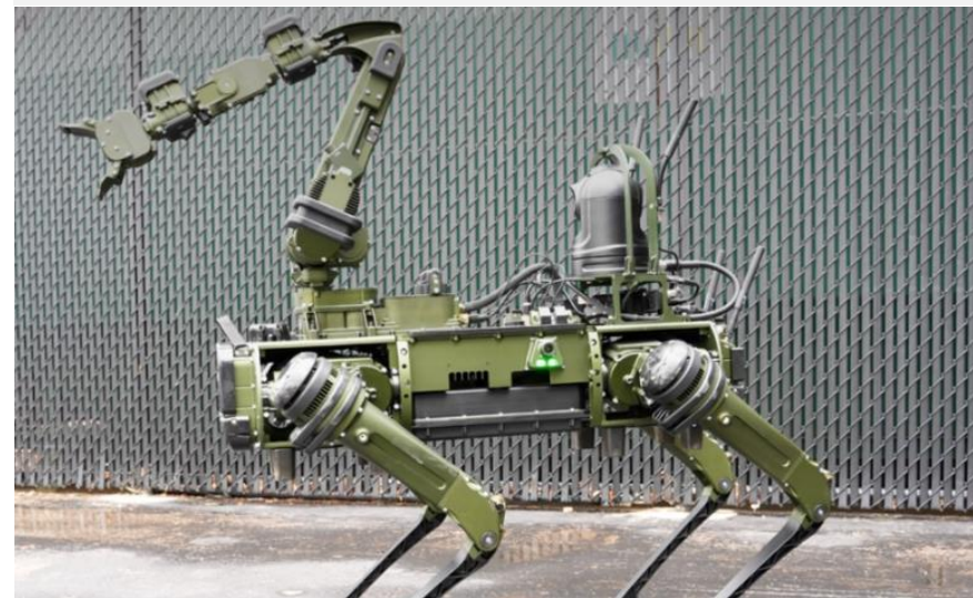
<그림> 'Vision60 에 로봇팔 형태의 모듈인 매니퓰레이터 암이 장착
