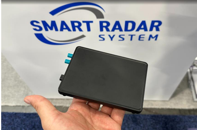
<그림> 스마트레이더시스템의 4D이미징 레이더는 자율주행, 드론, 스쿨버스 등에 다양하게 사용되며 물체의 유무 뿐 아니라 대략적인 이미지도 파악 가능
