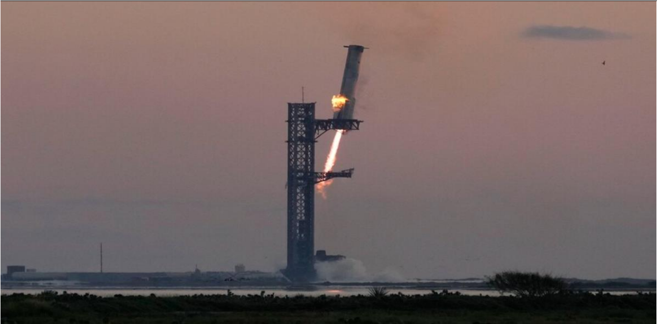
그림18. 스페이스 X의 슈퍼헤비 로켓이 발사 후 귀환해 '젓가락 팔' 모양의 발사탑에 성공적으로 포착되는 모습.
