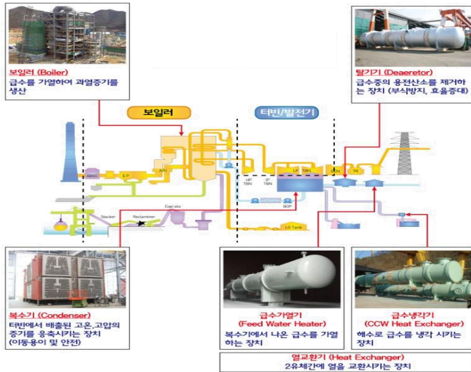
그림16. 화력 발전과정 및 비에이치아이 주요 제품
