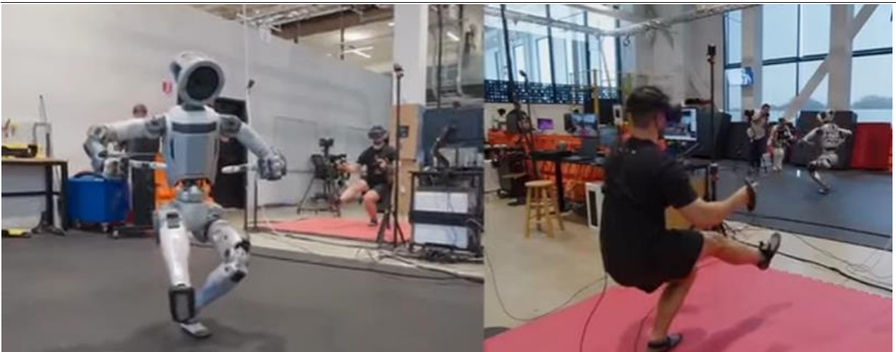
그림254. Teleoperation 방식으로 초기 학습 데이터를 수집 중인 Atlas
