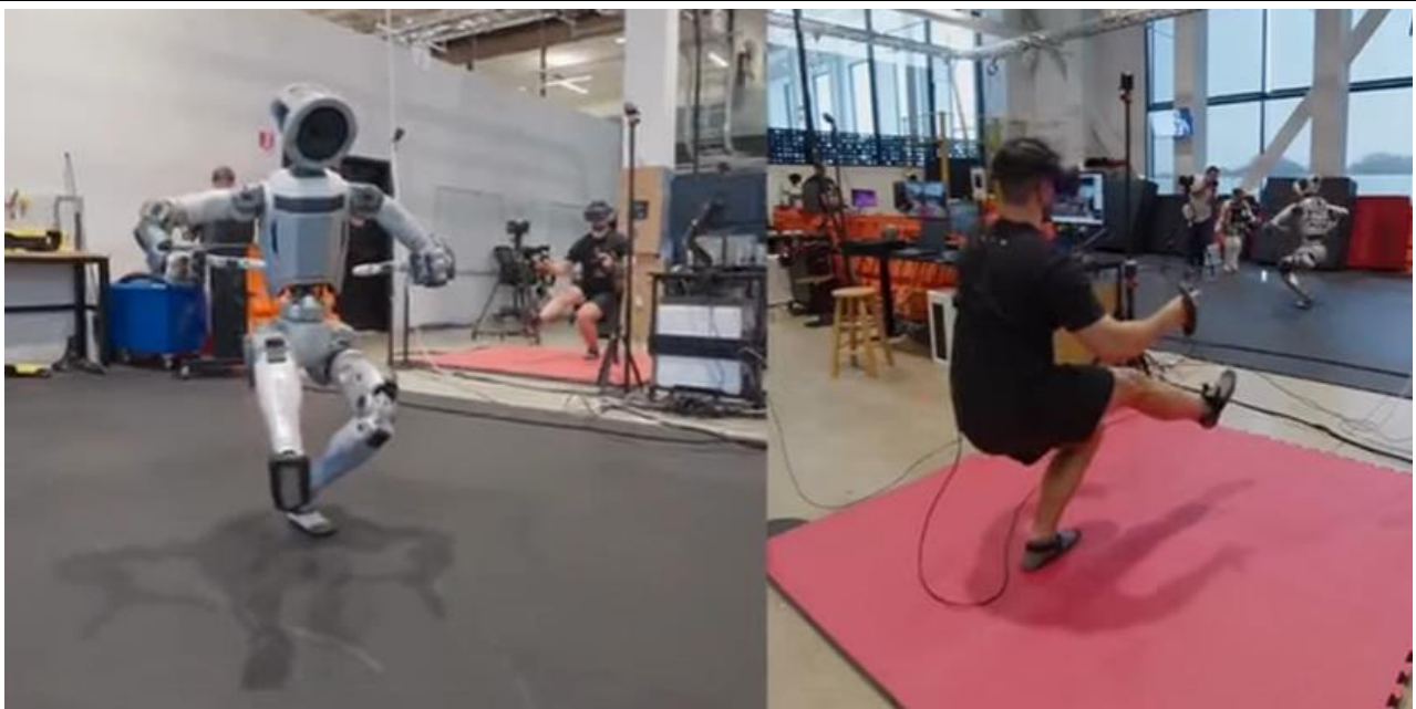
그림9. Teleoperation 방식으로 초기 학습 데이터를 수집 중인 Atlas
