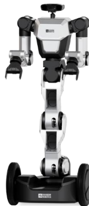
그림7. 레인보우로보틱스의 차륜형 휴머노이드 RB-Y1
