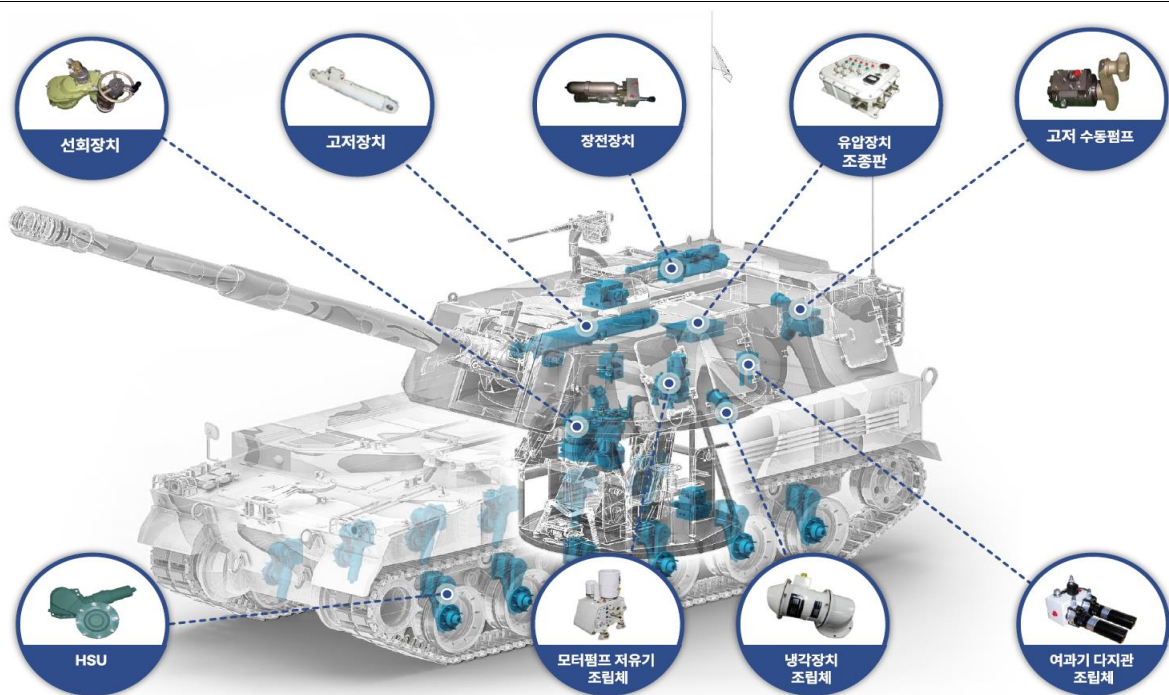
그림10.엠앤씨솔루션 K9 자주포 유압구동 및 현수장치
