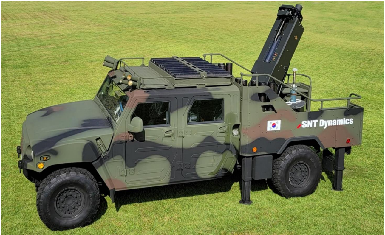
그림11. SNT 다이내믹스 소형전술차량(LTV) 탑재형 120mm 박격포체계
