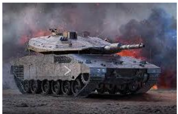
그림4. 이스라엘의 Merkava 전차: 포탑 면적을 최소화하고 전면엔 큰 경사각을 주어 피탄 면적을 줄이고, 두꺼운 장갑 채택
