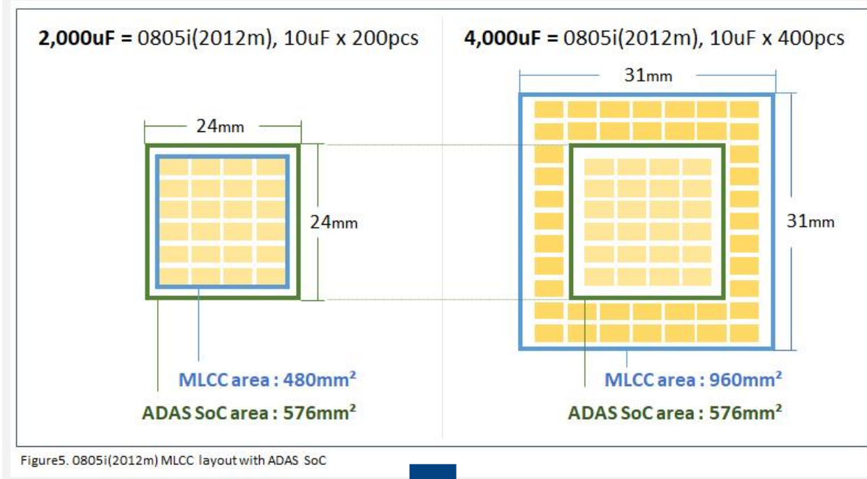
그림8. 고용량 MLCC를 탑재하면 동일한 면적에서도 더 많은 Capacitance를 확보하는 것이 가능해진다
