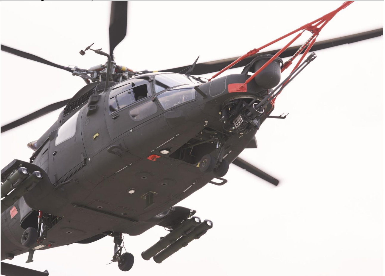
그림10.LAH(Light Armed Helicopter)에 부착된 터렛형 기관총 시스템(TGS)
