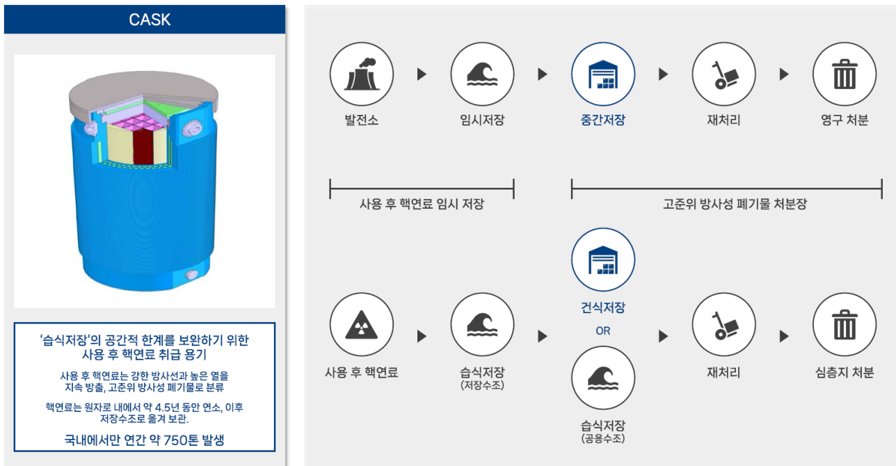
그림10.CASK 개요 및 사용 후 핵연료 관리
