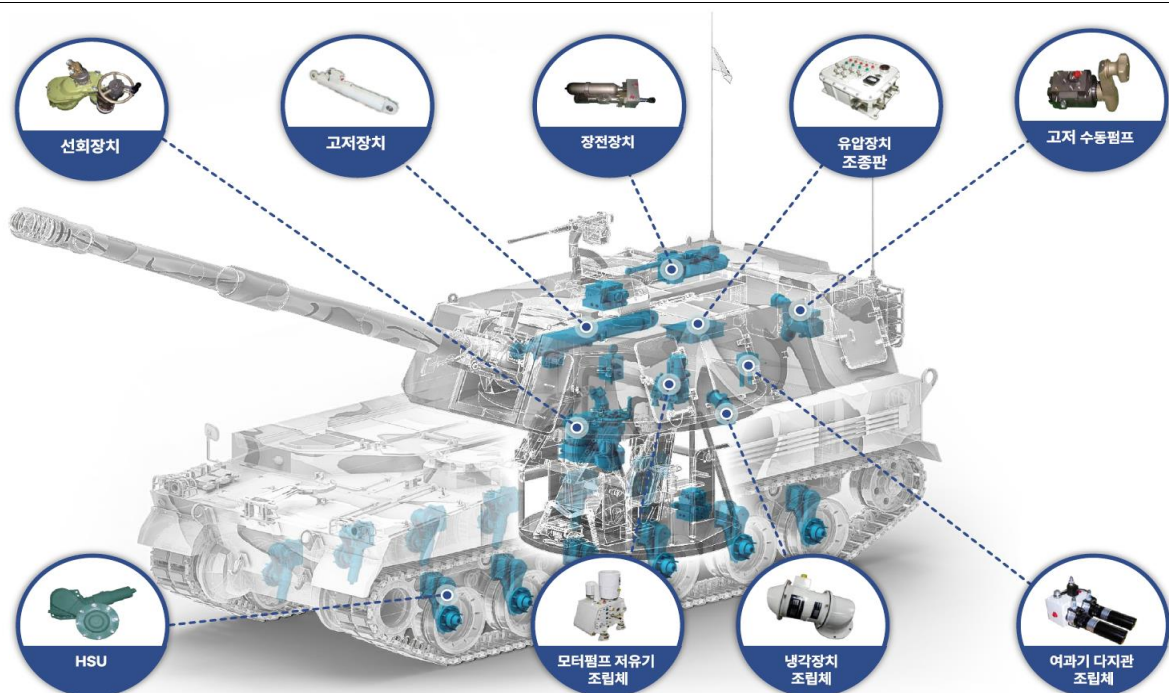
그림8.엠앤씨솔루션 K9 자주포 유압구동 및 현수장치
