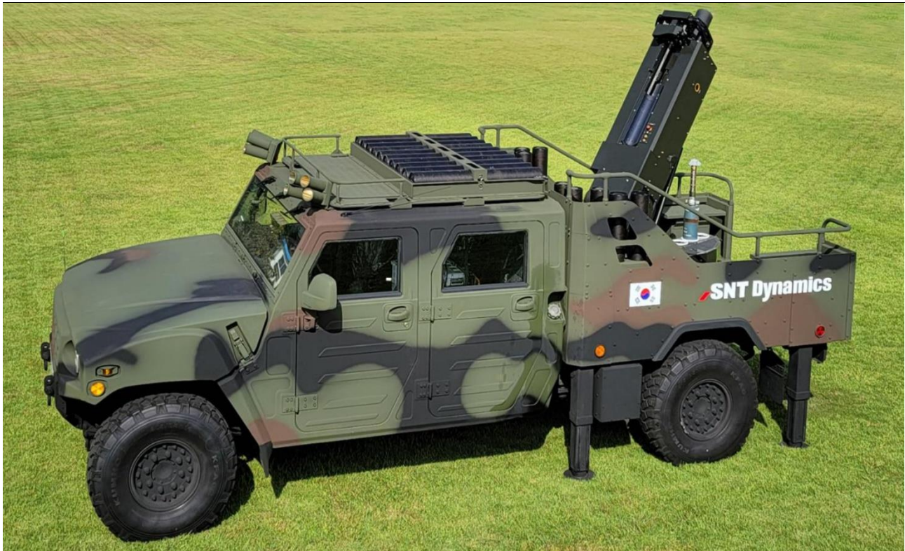
그림9.SNT 다이내믹스 소형전술차량(LTV) 탑재형 120mm 박격포체계
