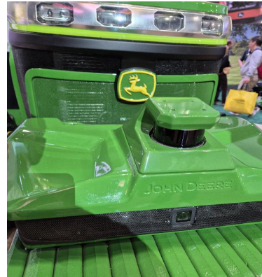
John Deere, LiDAR 탑재한 자율주행 트랙터
