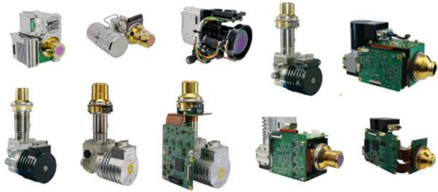
그림 201. 냉각형 적외선 검출기(모듈 및 카메라 엔진 포함) 라인업
