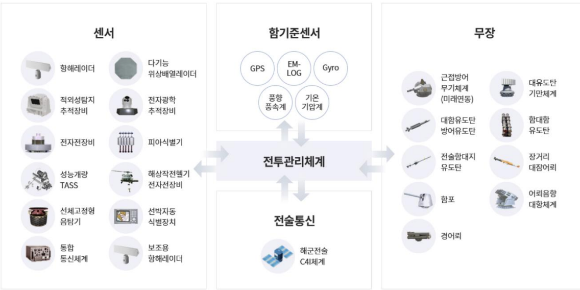
그림 146. FFX Batch-III(울산급 호위함) 전투관리체계
