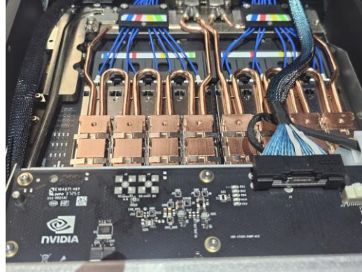
그림 30. NAND Switch Board Liquid Cooling
