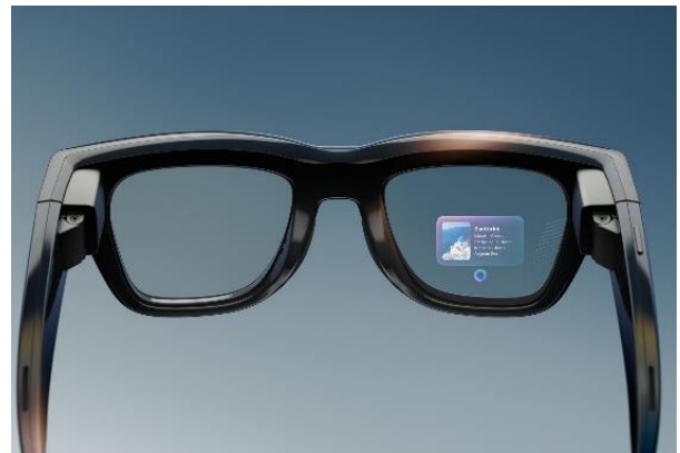
그림 45. Meta, Ray-Ban Display 웨이브가이드 적용
