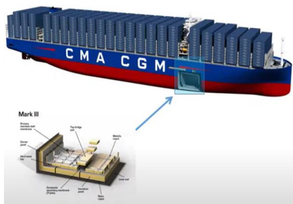
그림 38. 멤브레인형 탱크: LNGc 화물창과 동일하게 2차 방벽 필요
