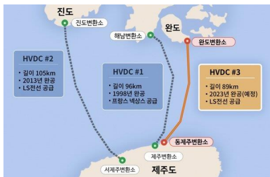
그림 23. 제주 연계 HVDC 해저케이블 현황
