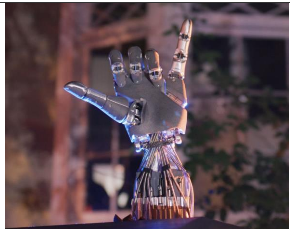
그림 50. Tesla의 Optimus Gen3의 손은 22 DoF 보유
