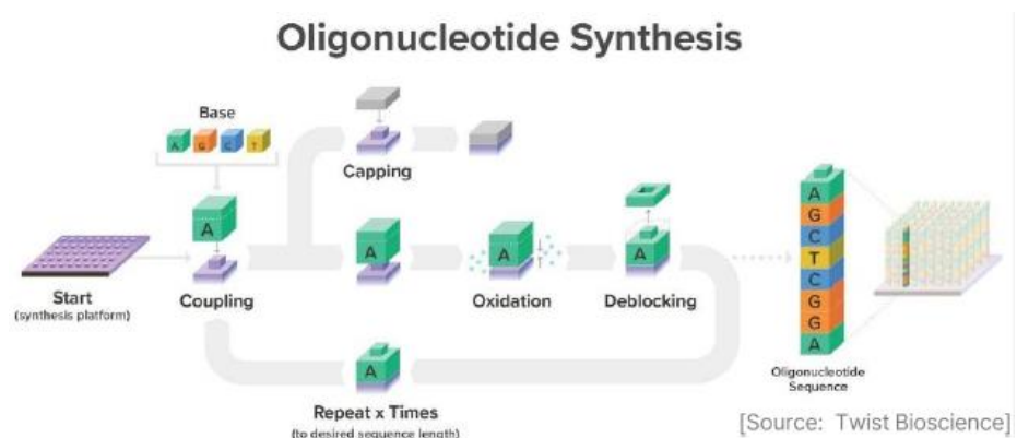
그림 35. 올리고핵산치료제 API 고체합성 생산 방식
