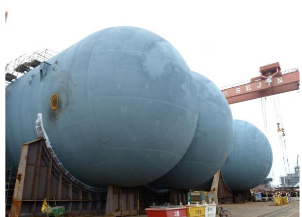
그림 133. 세진중공업의 Bilobe Type LCO2 탱크
