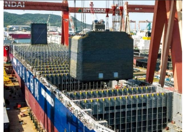
그림 101. LPGc, LNG BV 탱크: 외부에서 제작 후 도크에서 탑재
