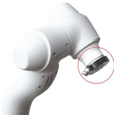
그림 66. 6축 관절에 적용된 힘/토크센서
