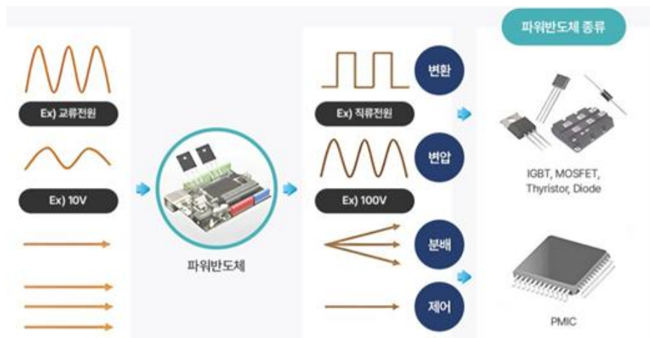
[그림 28] 전력반도체 주요 기능: 변환, 변압, 분배, 제어 등
