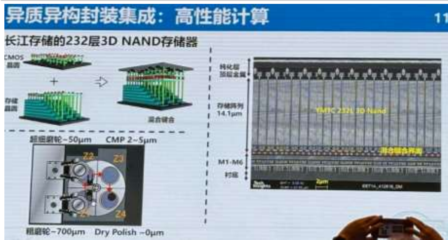
그림 73. YMTC의 Hybrid bondin을 활용한 232단 NAND: CMP 공정 중요도 증가
