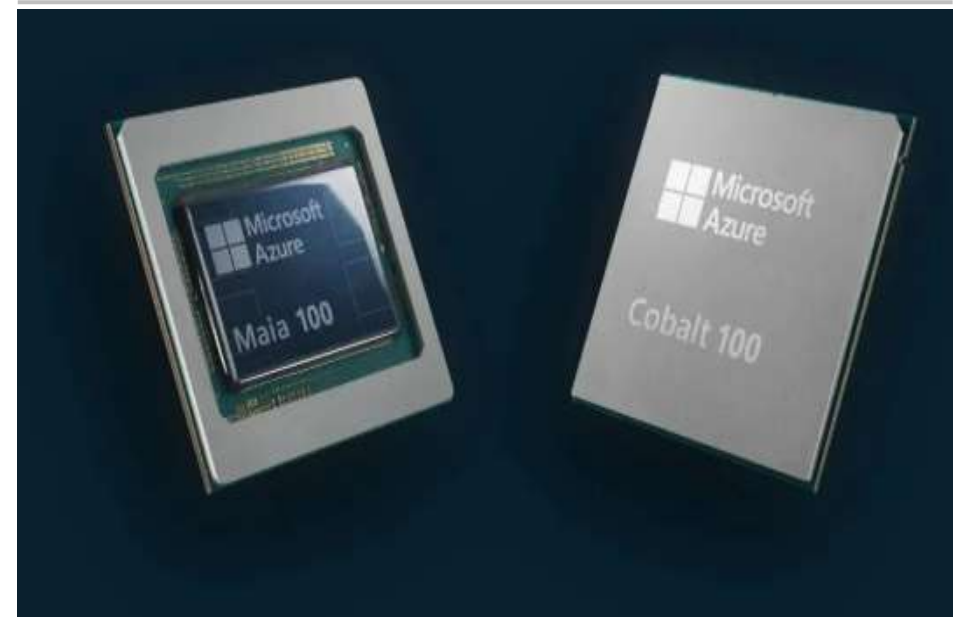
그림 05. Microsoft사의 자체 개발 GPU(Maia 100)와 CPU(Cobalt)
