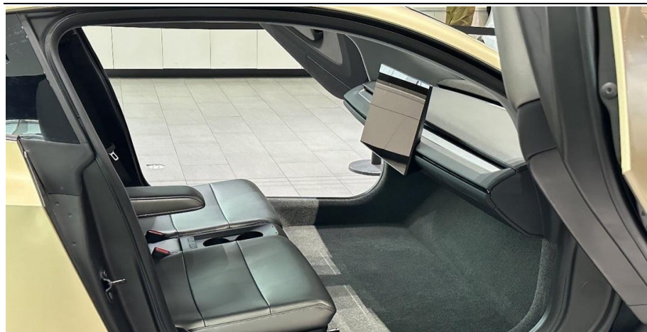
[그림1] 테슬라 사이버캡(Cybercab) 실내 - 운전대와 페달 삭제
