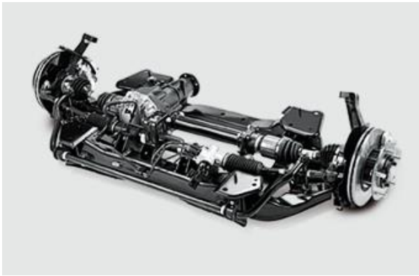
[그림65] 기존 자동차 차시모델 구조: 정형/복잡 메커니즘
