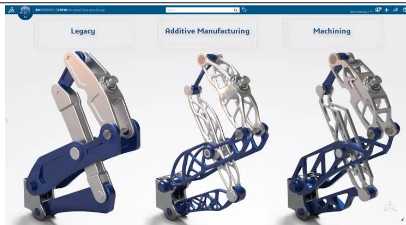
[그림79] 제조 설비/공법에 따라 설계 최적화 제안
