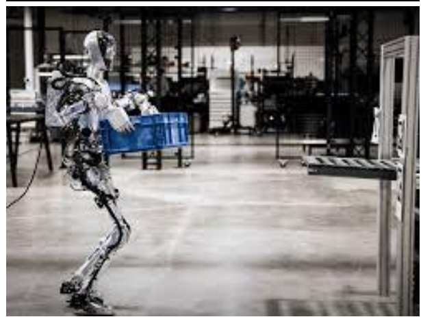
[그림83] BMW 스마트팩토리 - 휴머노이드 로봇(Figure) 적용
