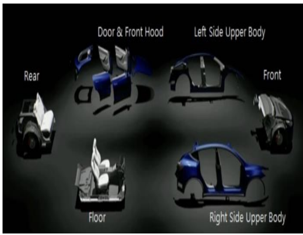
[그림80] 테슬라 - Unboxed Process 6 개 모듈
