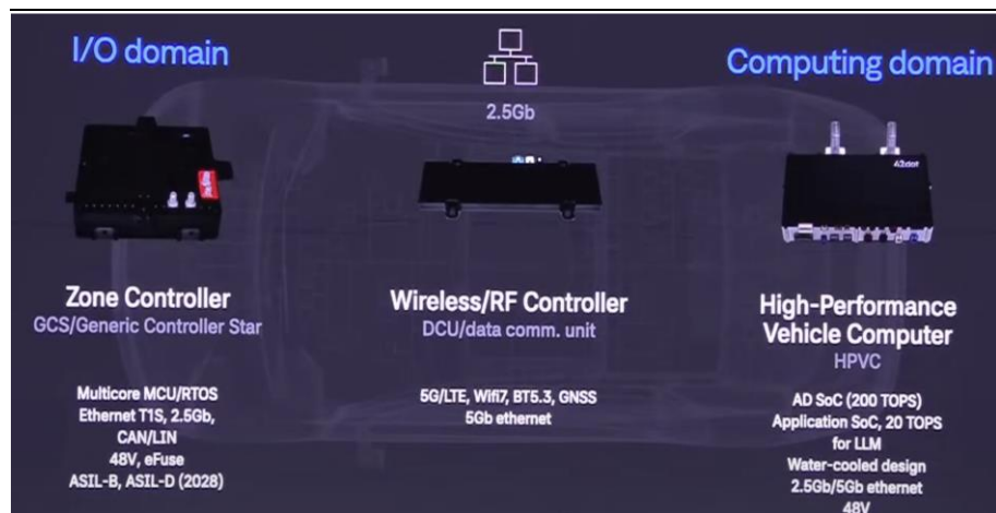
[그림2] (SDV HW) Zonal 아키텍처 형태의 SDV HW 구조는 단순화/표준화
