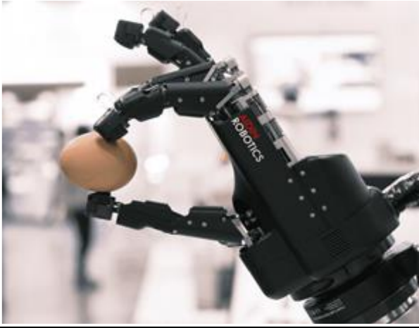
[그림84] 촉각센서 통한 매니퓰레이터 압력 제어(에이딘 로보틱스)
