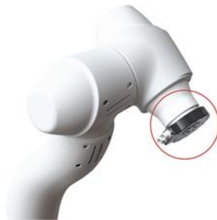
[그림77] 행동/동작 데이터 생성 디바이스 - 촉각센서(에이딘로보틱스)
