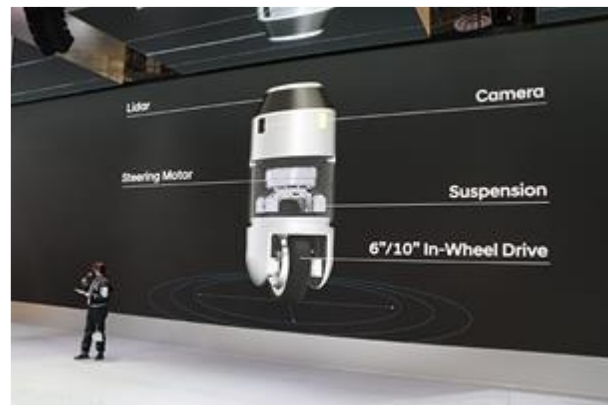
[그림79] 현대차 로봇 드라이브 모듈(PhD)- 제어와 동작 데이터 생성
