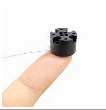
[그림85] 매니퓰레이터에 적용된 초소형 6축 센서(에이딘 로보틱스)
