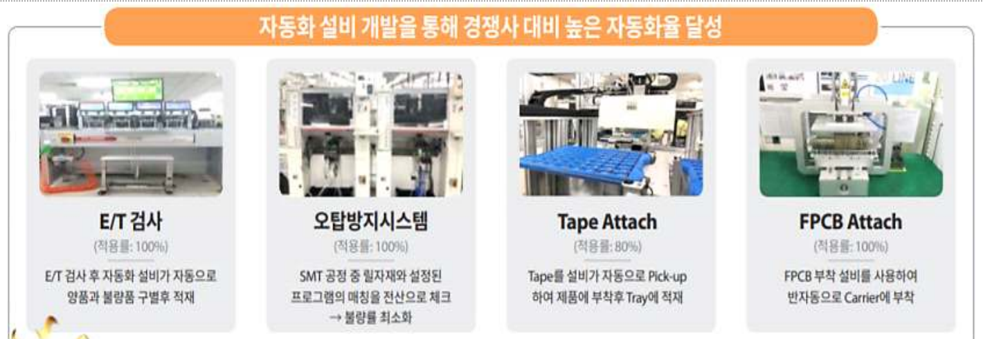
그림 4. 표면실장기술을 적용한 FPCA 제조 과정
