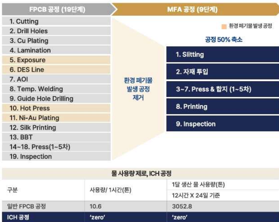
그림 5. FPCB 제조 공정과 동사의 상온 프레스 패터닝 공정 기술 비교
