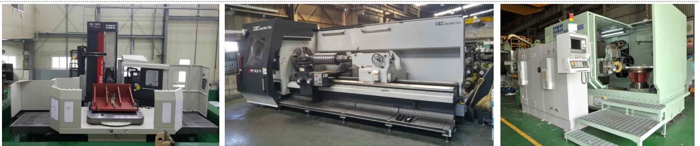
[그림 3] 동사의 CNC 수평보링기, CNC 수평선반, CNC 기어 연마기 설치사례
