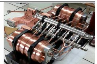
SLED(에너지 배가장치) (X-FEL 방사광가속기 적용)
