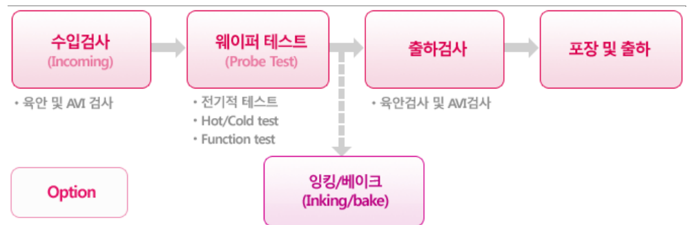
반도체 웨이퍼 테스트 Flow
