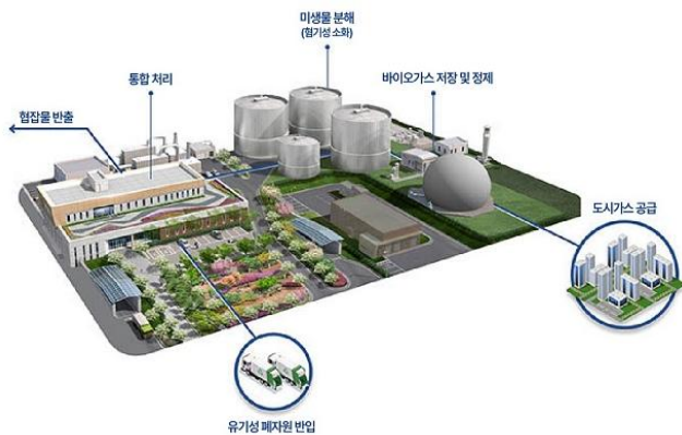
시흥 바이오가스 고질화시설 주요 처리 및 에너지화 과정
