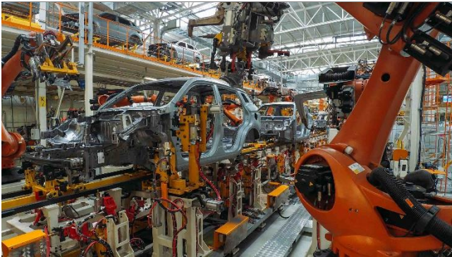
자동차 제조 시 대부분의 공정은 Jig와 로봇 등을 통해 이미 자동화 구현
