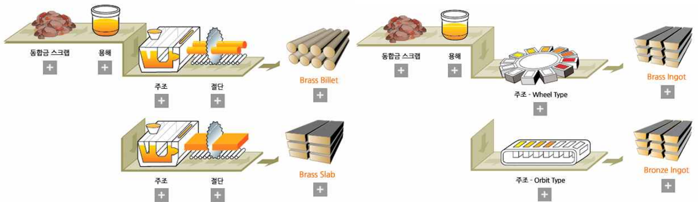
그림 3. 동사의 황동 빌레트 및 인고트 생산과정
