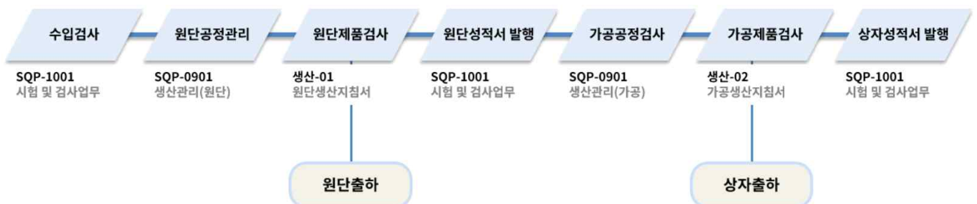
그림 9. 골판지 원단 및 상자 생산 공정도
