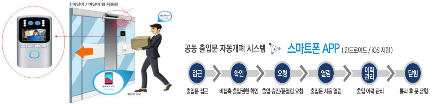
그림 7. IoTPass 아파트 자동 출입문 출입 시스템 구성도
