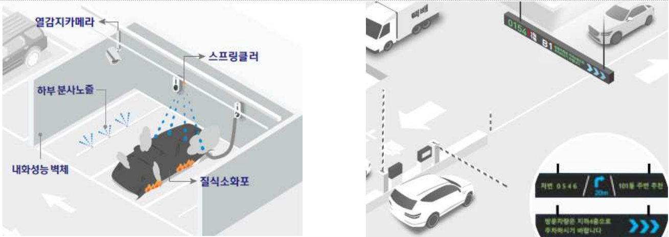
그림 5. 주차장 화재방지 시스템(좌) 및 차량 인식 AI 주차유도 안내 시스템(우)
