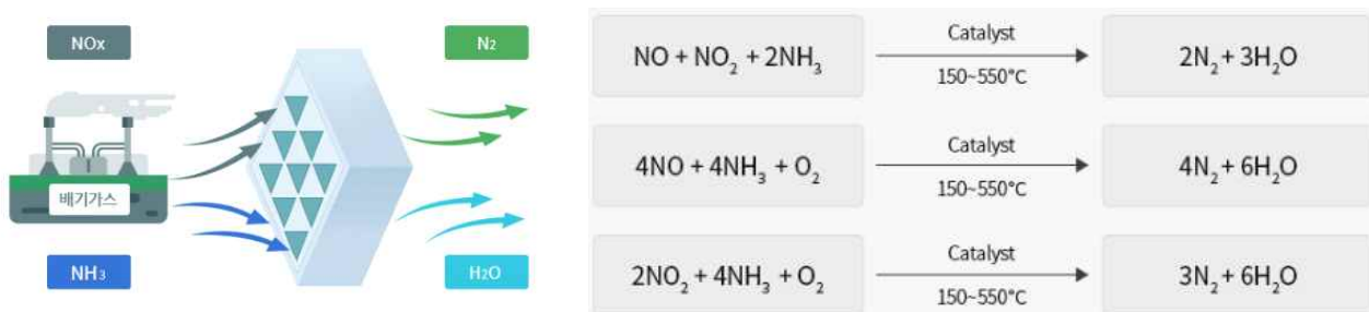
그림 4. SCR 탈질 촉매가 질소산화물을 제거하는 과정
