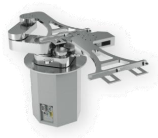
반도체 웨이퍼 운송장치에 적용되는 360도 회전영역 가진 진공 로봇
