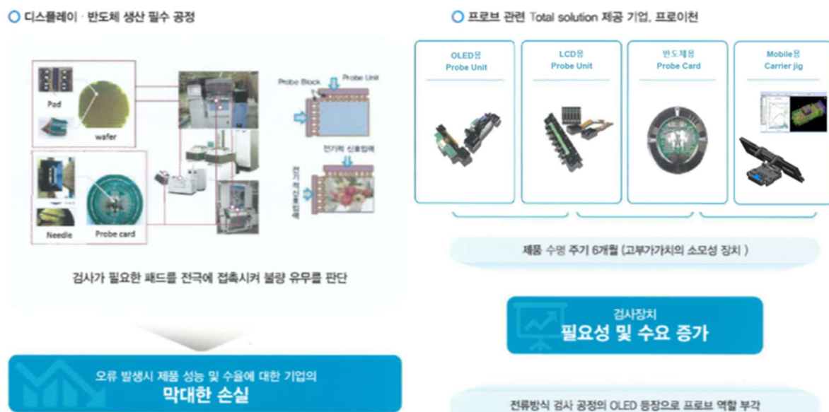
도표 13. 디스플레이, 반도체 검사장비를 연결하는 핵심, 검사장치 (Probe)
