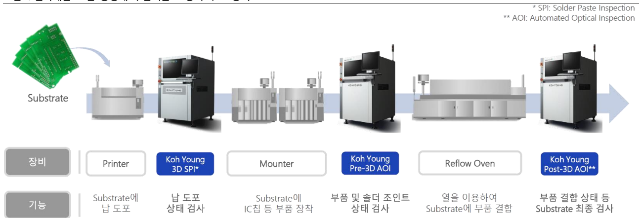
그림4. 전자제품 조립 공정에 투입되는 고영의 주요 장비
